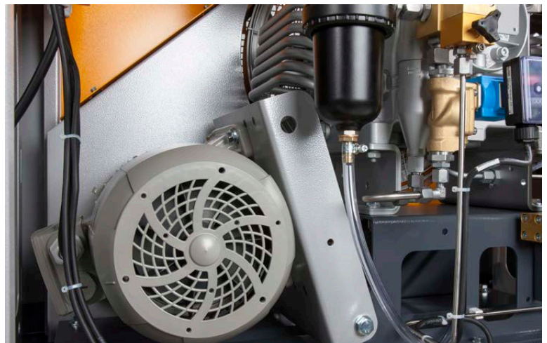
PE-HE: Dank der integrierten Motorwippe ist auch in der horizontalen Ausführung kein Nachspannen des Keilriemens erforderlich.
