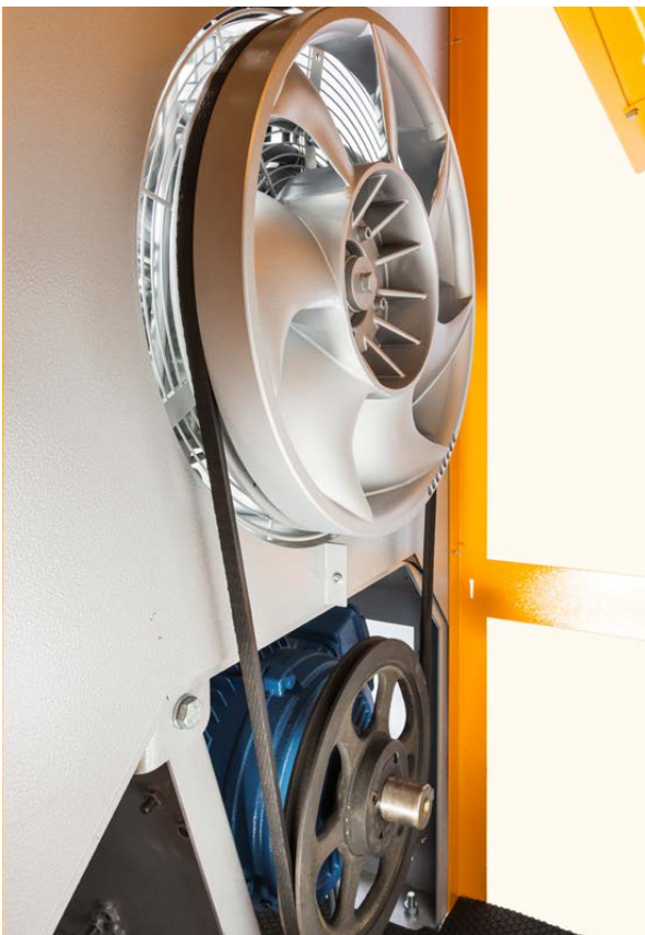
Blick ins Innere des PE-VE: Dank vertikaler Anordnung und hängender Lagerung des Motors ist kein Nachspannen des Keilriemens erforderlich.
